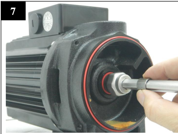
依序裝上彈簧、保護蓋及 12mm 軸套
