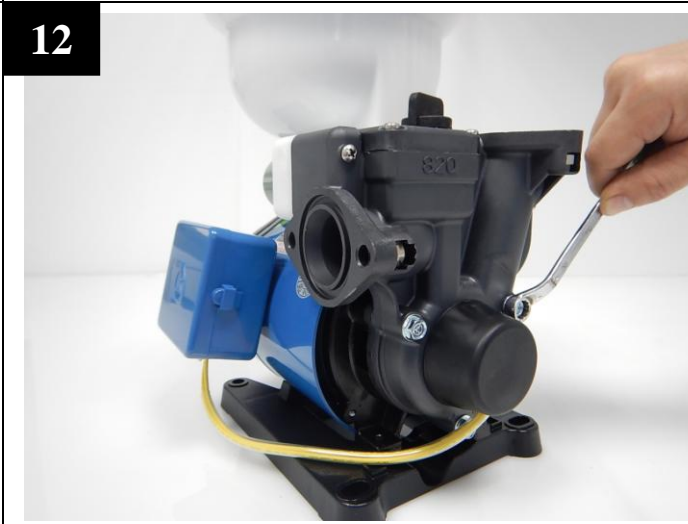
12 裝上水機身且利用 10 號梅花扳手鎖緊螺絲 ※扭力設定：50-60kgf · cm
