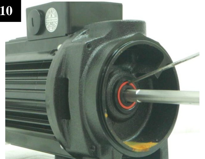
利用一字起子插入橡膠與定部接縫處，挖起定部後 取下橡膠部份
